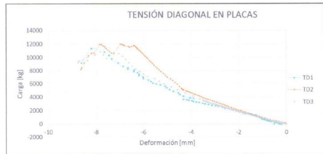
Figura 5. Carga vs Deformación del ensayo tensión diagonal
