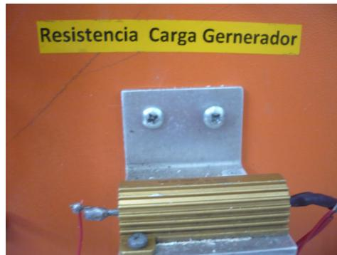
Figura 3.27 Resistencia de carga del generador.
