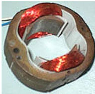
Figura 2.6 Estator con bobina independiente
