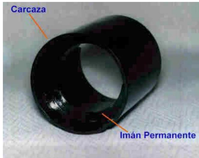
Figura 2.7 Estator imán permanente
