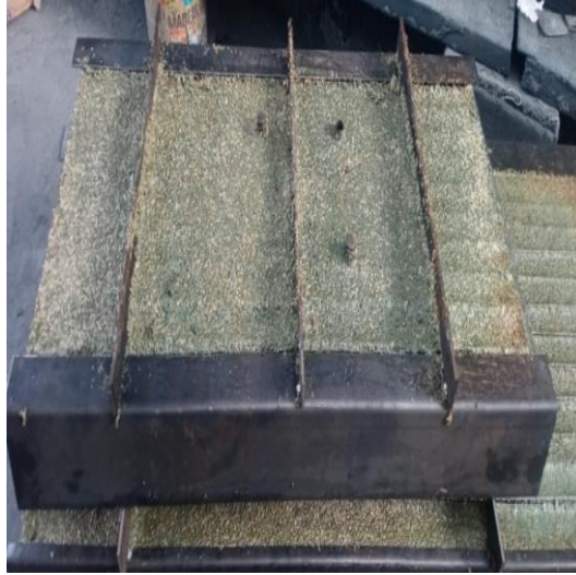
Figura 12. Molde de puerta con plástico procesado y cerámica
