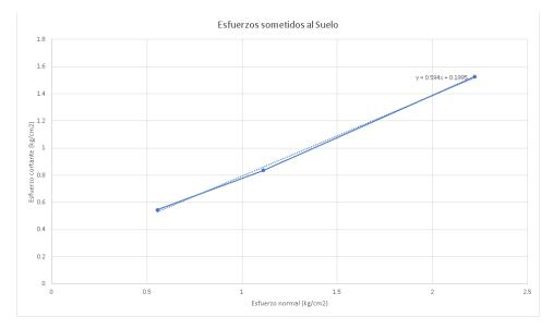
Si se interpolan los puntos y se obtiene una recta de regresión lineal se obtienen los valores de la cohesión que es de 0.20 kg/cm2 y también del ángulo de fricción interna cuyo valor es de 30.7°.
