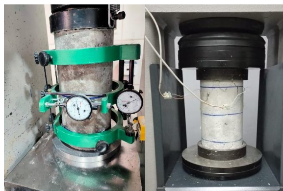
a) Anillos de sujeción b) Galgas extensiométricas Figura 8. Ensayo compresión simple-módulo de elasticidad
