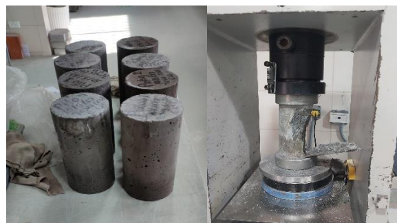
Figura 6. Ensayo a compresión simple de cilindros de hormigón.
