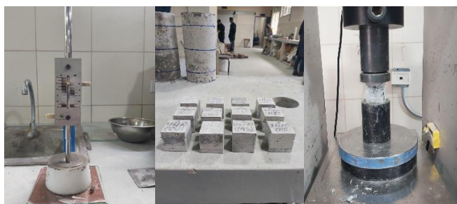
Figura 7. Ensayo de consistencia, elaboración de cubos de pasta de cemento-ensayo a compresión simple.
