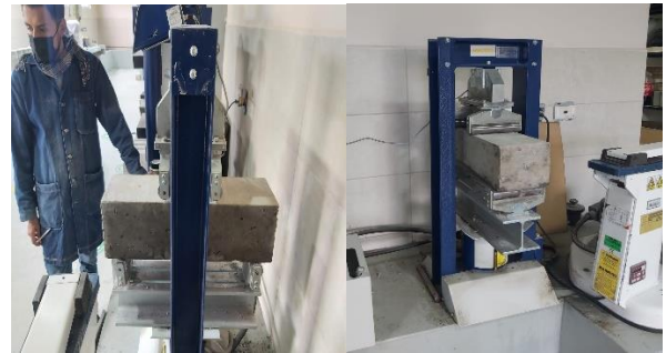
Figura 11. Ensayo a flexión en viga de hormigón.
