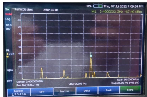
Figura 8. Señal transmitida en el Fronthaul a 2.4 GHz en Fieldfox.
