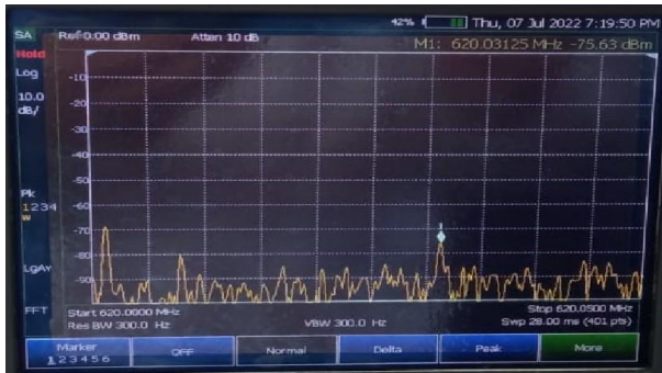
Figura 5. Señal transmitida en backhaul a 620MHz en Fieldfox.
