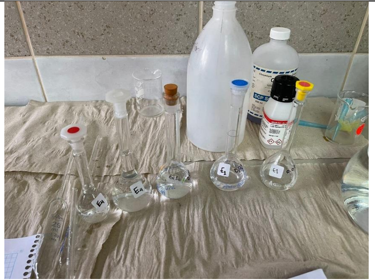
Preparación de estándares de Cr, Pb y Hg para la generación de curva de calibración.
