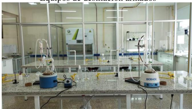
*Figura 6* Equipos de destilación
