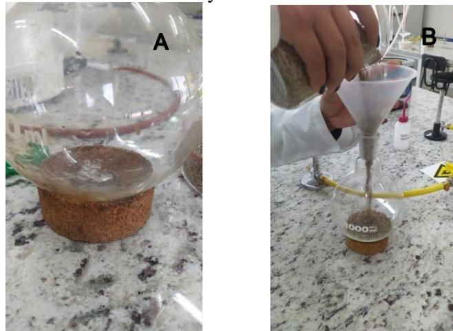
*Figura 4* Adición de núcleos de ebullición y la semilla en el matraz de fondo redondo
