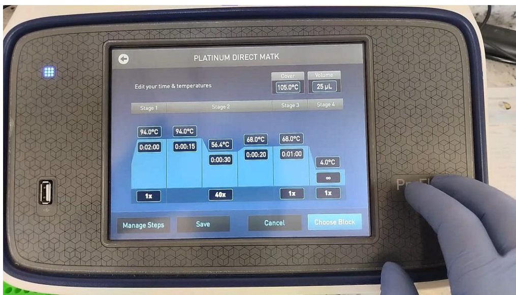
Anexo 5.- Programación del termociclador para PCR convencional Amplificación del gen Ap2 en Epidendrum nocturnum . Elaborado por: (El autor, 2023)
