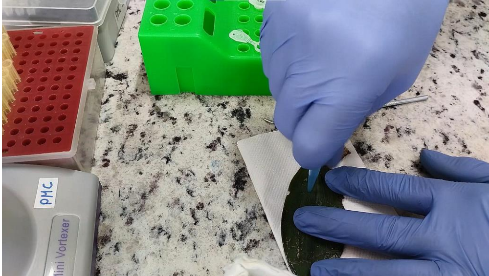
Anexo 3.- Extracción de ADN por el método del kit Platinum Direct Universal PCR Master Mix .
