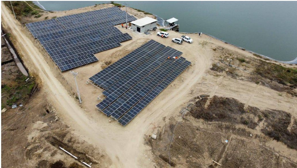
Figura 1.1: Proyecto fotovoltaico de 413,8 [KW] ubicado en la finca de banano orgánico Don Polo, provincia de Santa Elena - Fuente: [1]
