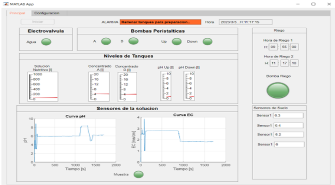
Figura 63: Interfaz del Sistema de Control
