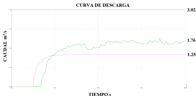
Figura 15. Curvas de descarga del separador de caudales con vertedero inclinado de 12 grados, Flow 3D
