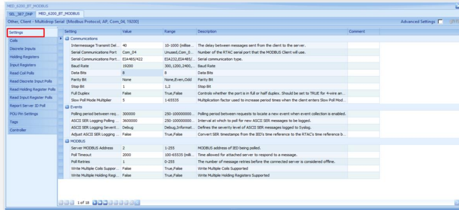
Figura 23: Configuración Medidor ION 6200
