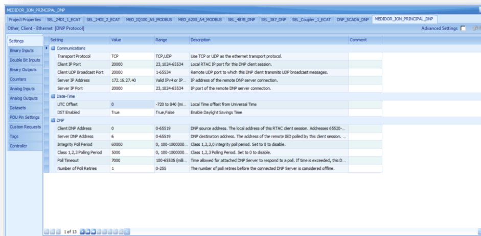
Figura 27: Configuración Medidor ION Principal
