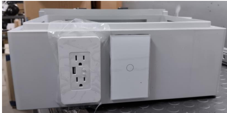
Figura 9: Interruptor y tomacorriente inteligentes
