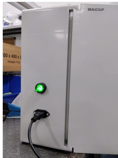
Figura 16: Entrada de voltaje y selector luminoso
