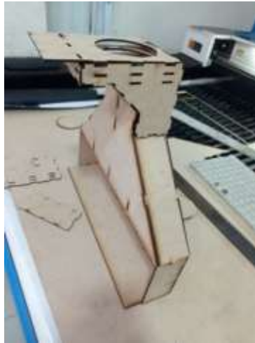
Figura 24. Prototipo en MDF para mejorar la eficiencia de la extracción de COV Fuente: Gigantografía R2M-Print Elaboración: Autor
