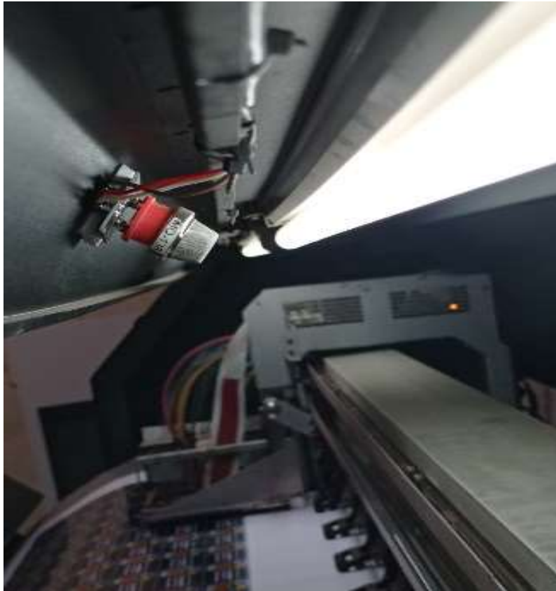
Figura 18. Sensor MQ 138 colocado en la máquina, foto durante impresión Fuente: Gigantografía R2M-Print Elaboración: Autor
