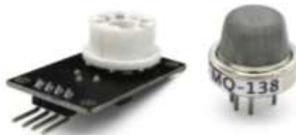
Figura 3. Sensor MQ 138 con tarjeta de circuito Fuente: Linecard – Winsen
