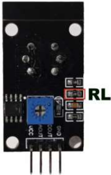
Figura 11. Tarjeta de circuito, con sus componentes, se detalla la RL de 1K \Omega
