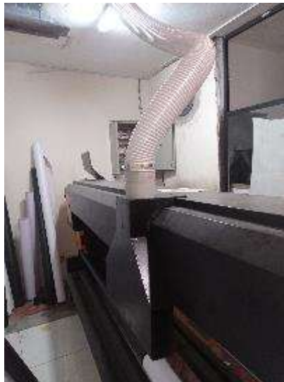
Figura 25. Foto de la máquina con los acoples traseros para extracción Fuente: Gigantografía R2M-Print Elaboración: Autor
