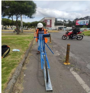
Calibración del Merlín en el tramo evaluado
