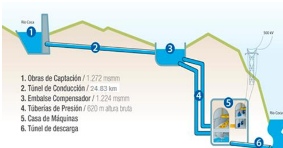
Figura 6. Obras de conducción.
