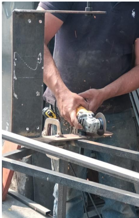
Figura 53. Proceso de corte de perfiles.
