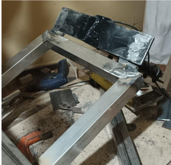
Figura 56. Pulido de la estructura.
