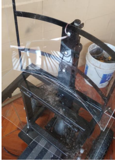
Figura 59. Policarbonato en la estructura.
