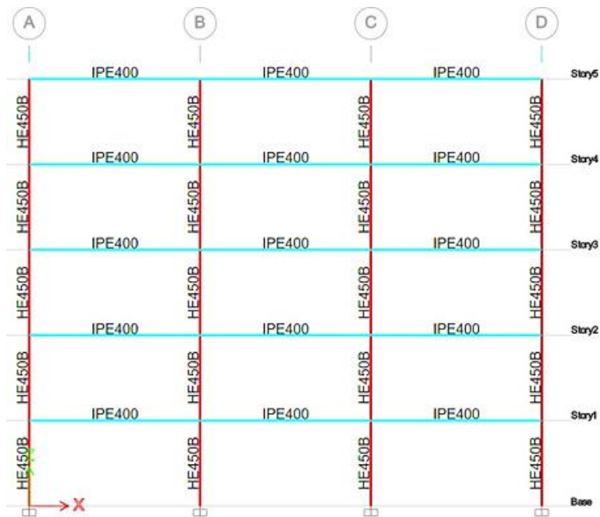
Figura 24. Columnas y vigas en ETABS
