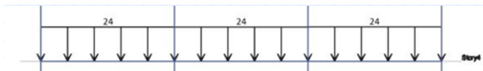
Figura 26. Carga permanente sobre las vigas
