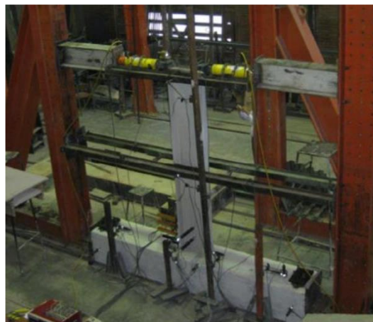
Figura 140 Banco de pruebas a escala real de la conexión WUF-W con columna de sección cuadrada.
