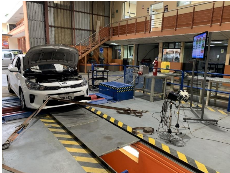
Figura 4.4: Arreglo experimental del vehículo sobre el banco dinamométrico
