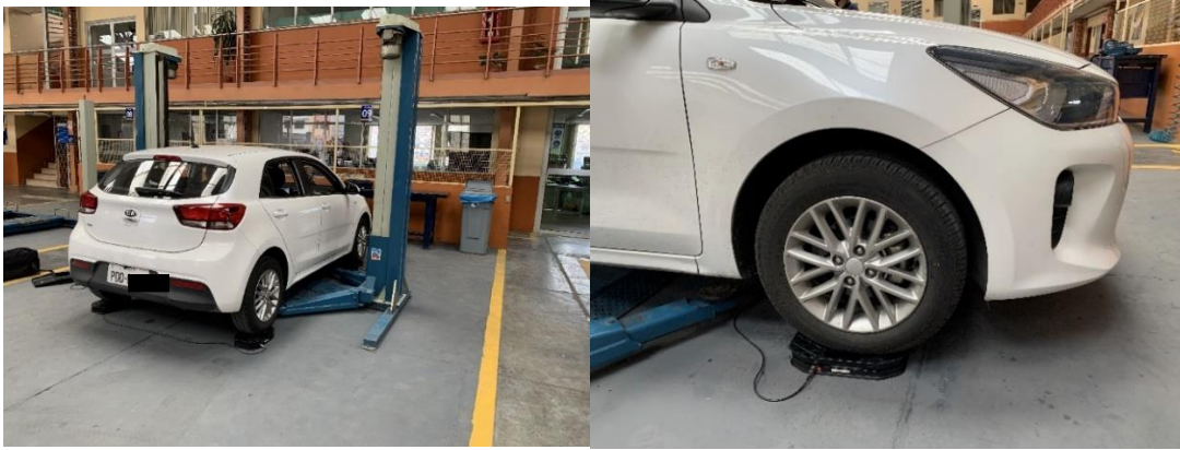
Figura 4.13 Medición de las masas del vehículo por poste de suspensión
