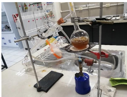
Figura 36. Obtención el bioetanol por medio de la destilación. Fuente: Autor
