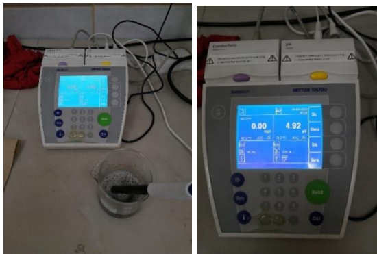
Figura 21. Medición del pH inicial de la muestra de lixiviado Fuente: Autor
