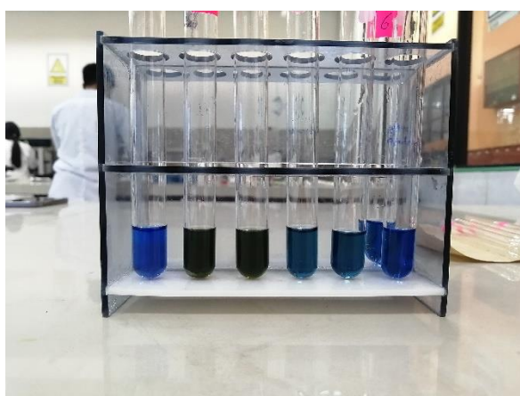
Figura 59. Azúcares reductores - Prueba de Fehling Fuente: Autor
