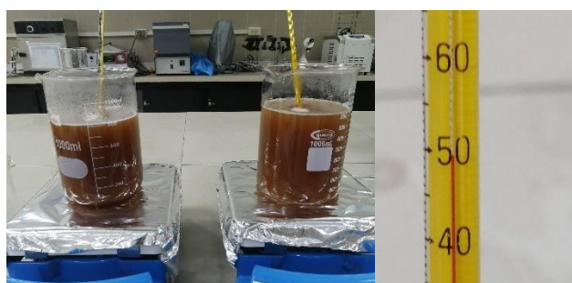
Figura 27. Proceso de hidrólisis enzimática y control de temperatura Fuente: Autor.
