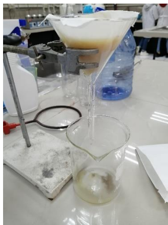
Figura 54. Filtración del lixiviado Fuente: Autor
