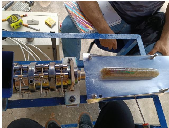
Figura 58. Prueba 4 Boquilla cilíndrica, plástico virgen con el mismo proceso de temperatura anterior .
