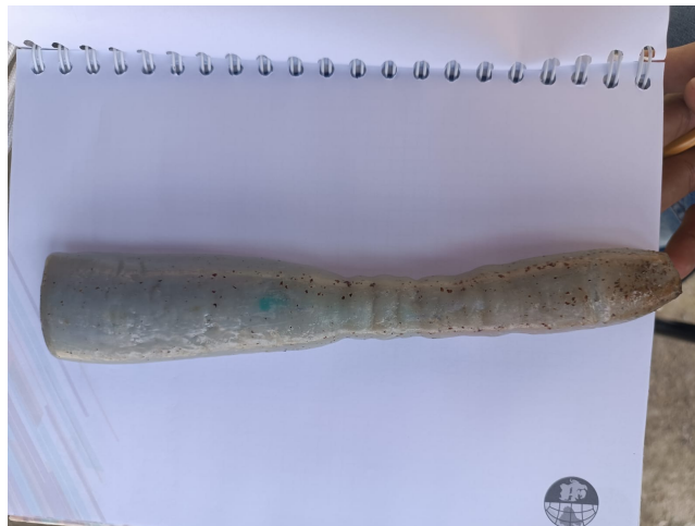
Figura 57. Prueba 4 Boquilla cuadrada plástico virgen con el mismo proceso de temperatura .
