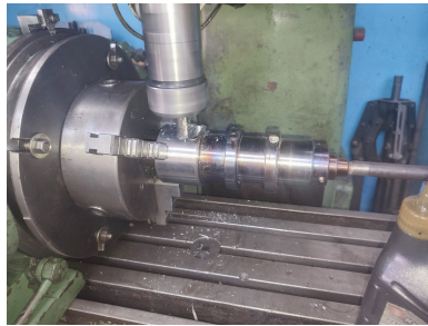
Figura 39. Fresado de agujero para suministro de plástico
