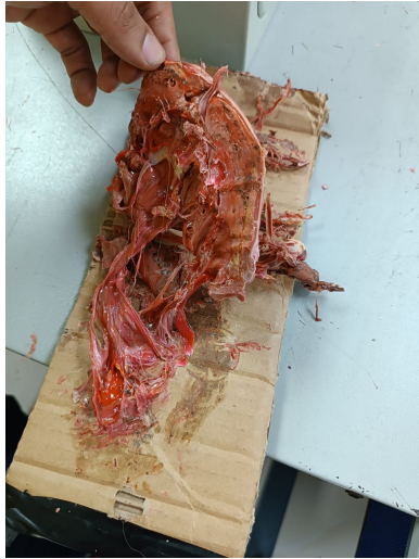
Figura 56. Prueba 4 Boquilla cuadrada plástico reciclado.
