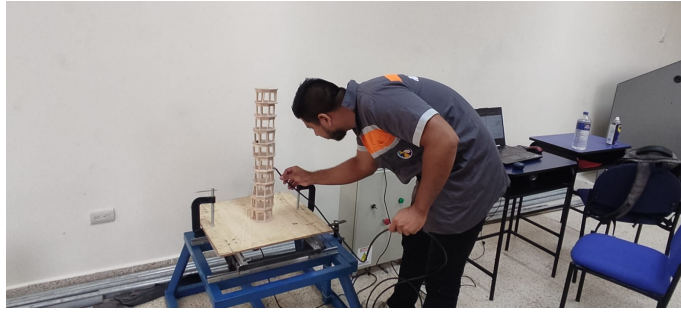
Figura 56: Colocación del sensor.
