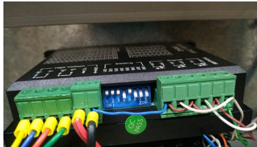
Figura 14. Configuración a 2000 pulsos/rev.
