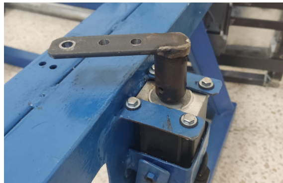
Figura 35: Manivela 75 mm x 40 mm.
