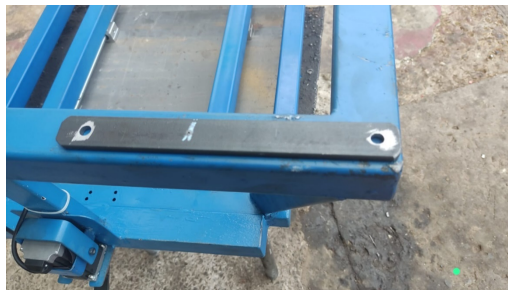
Figura 34: Biela de 150 mm x 40 mm.
