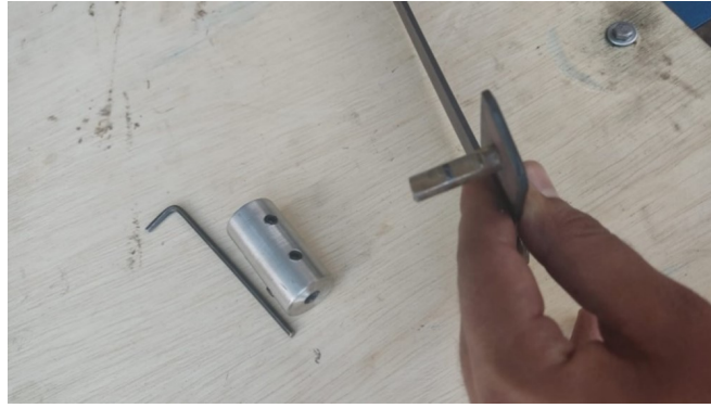
Figura 36: Acople de acero torneado para motor paso nema.
