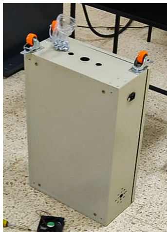
Figura 43: Instalación de ruedas.
