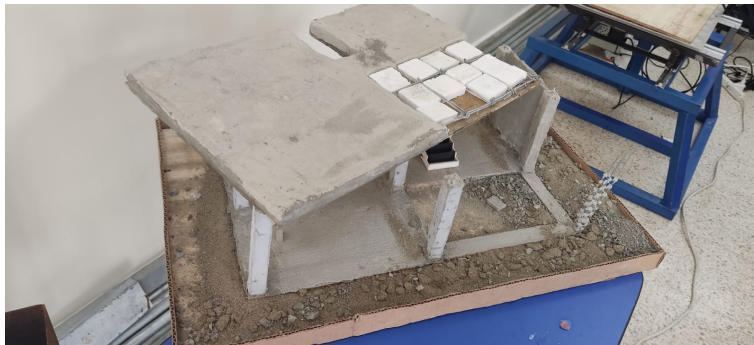
Figura 63: Colapso estructura concreto.
