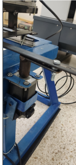
Figura 13: Mecanismo biela corredera.
