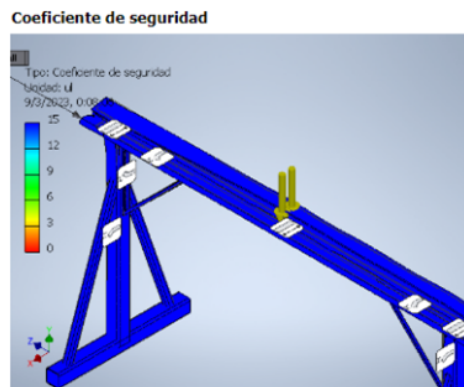
Figura 40. Factor de seguridad en el puente
