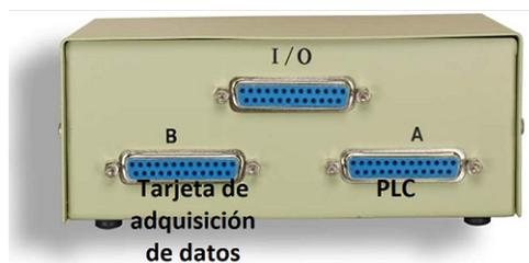
Figura 16. Conexión de DB25 Manual Data Switch Box: autores
