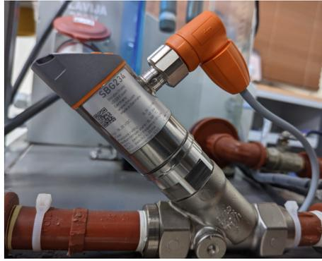
Figura 13. Sensor de Flujo SBG234 Vista Izquierda Fuente: autores
