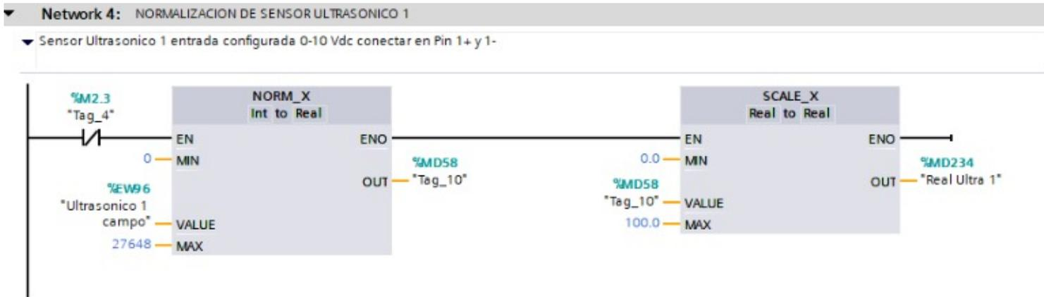
Figura 17. Sensor ultrasónico tanque 1 en TIA PORTAL: autores
