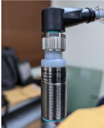
Figura 9. Sensor Ultrasónico de Tanque 2 Fuente: autores
