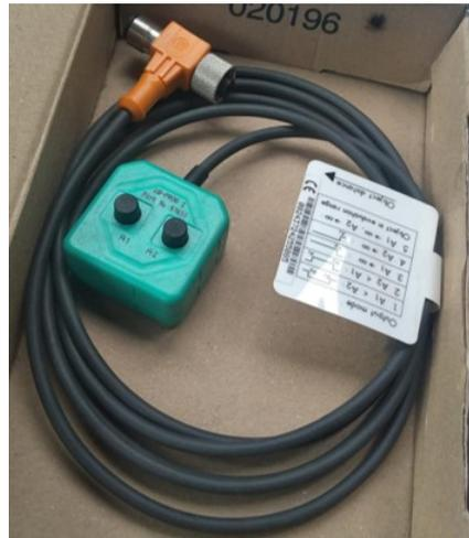
Figura 11. módulo de programación para sensor ultrasónico Fuente: autores
