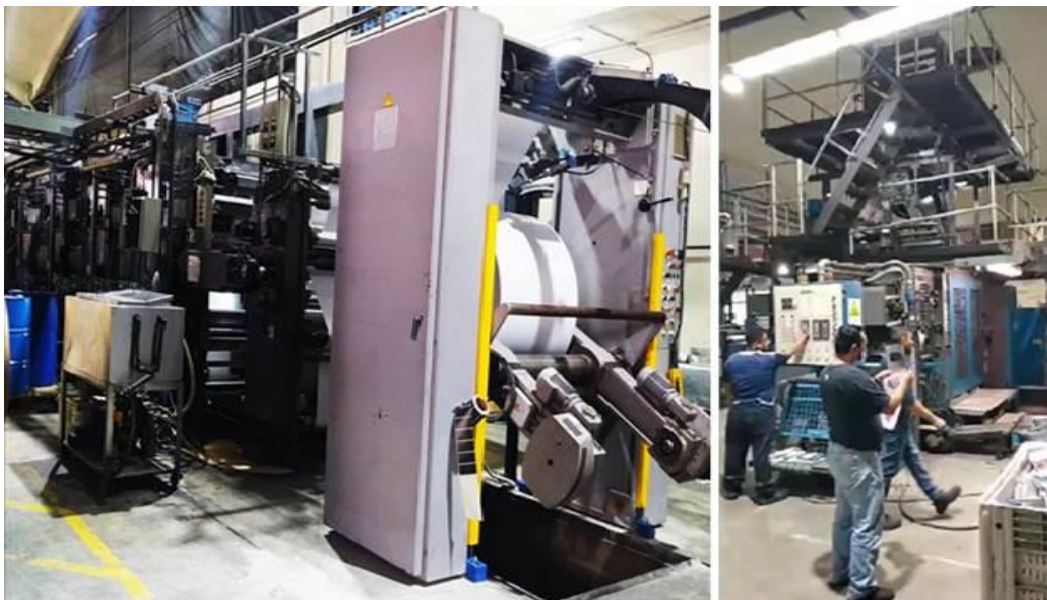
Figura 15. Impresora Rotativa: porta bobinas y doblador
