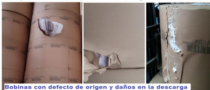
Figura 20. Merma por incorrecta manipulación en descarga contenedores
