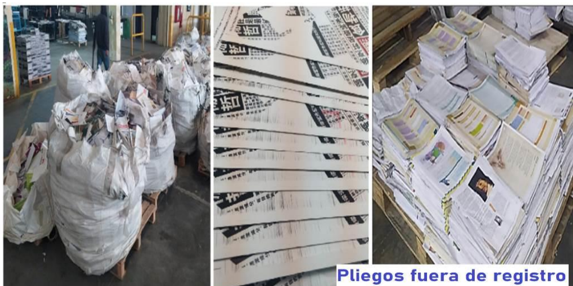
Figura 22. Desperdicio en producción, productos fuera de parámetros de calidad
