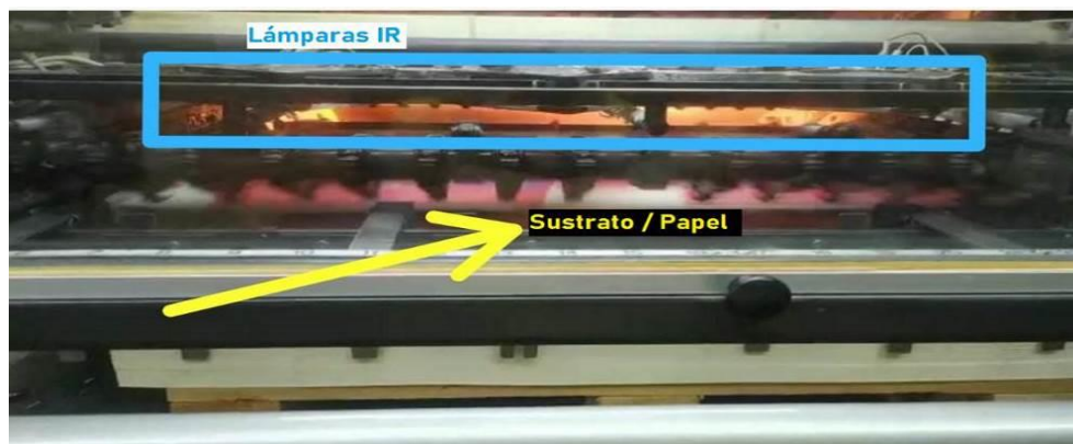
Figura 12. Lámparas infrarrojo (IR) para secar pliego impreso
