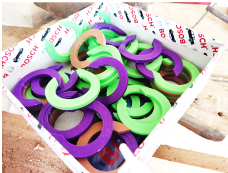
Figura 17. Asentamientos de PLA para fijar los discos piezoeléctricos a la base.
