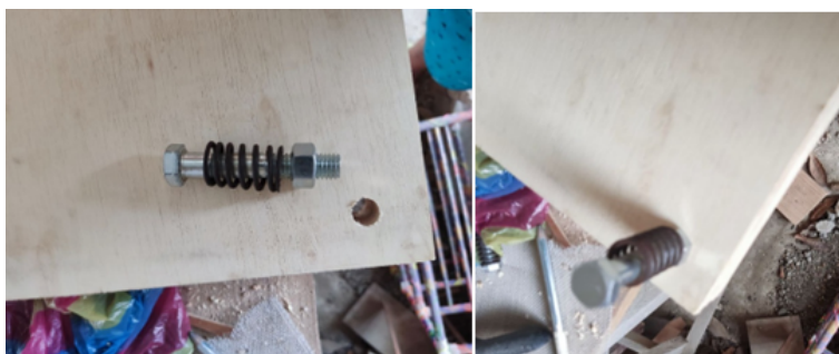
Figura 24. Resortes para amortiguar el impacto durante el contacto del usuario con la alfombra.
