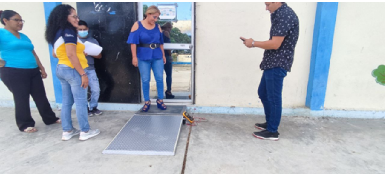
Figura 57. Lectura durante utilización de alfombra piezoeléctrica, por E. Alvarado y C. Verdezoto
