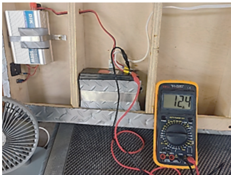
Figura 37. Lectura de voltaje almacenado en alfombra antes de realizar las pruebas.
