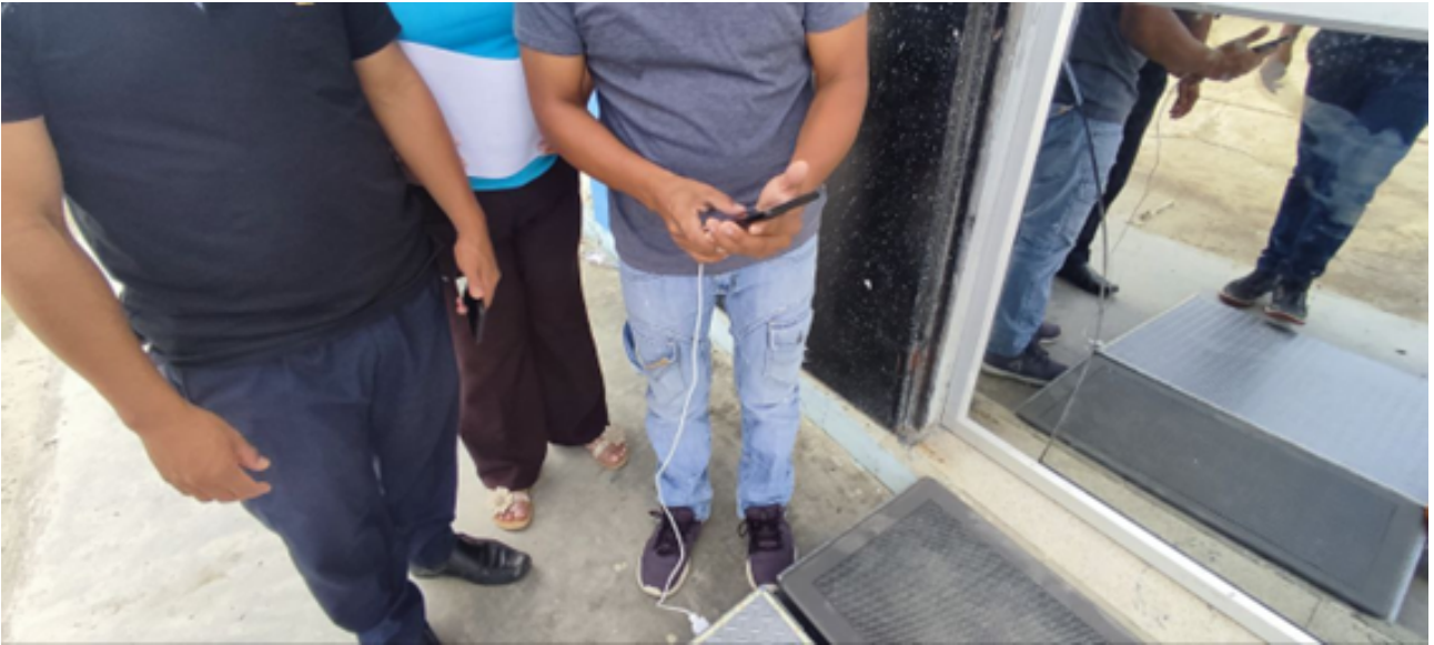
Figura 56. Carga de dispositivo móvil mientras se realiza la deformación de piezoeléctricos, por E. Alvarado y C. Verdezoto
