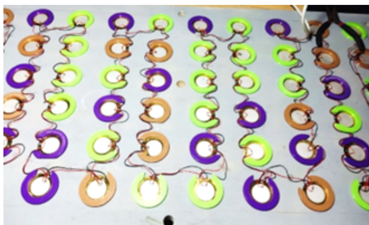
Figura 18. Adhesión de los anillos y los dispositivos piezoeléctricos a la base de Plywood.
