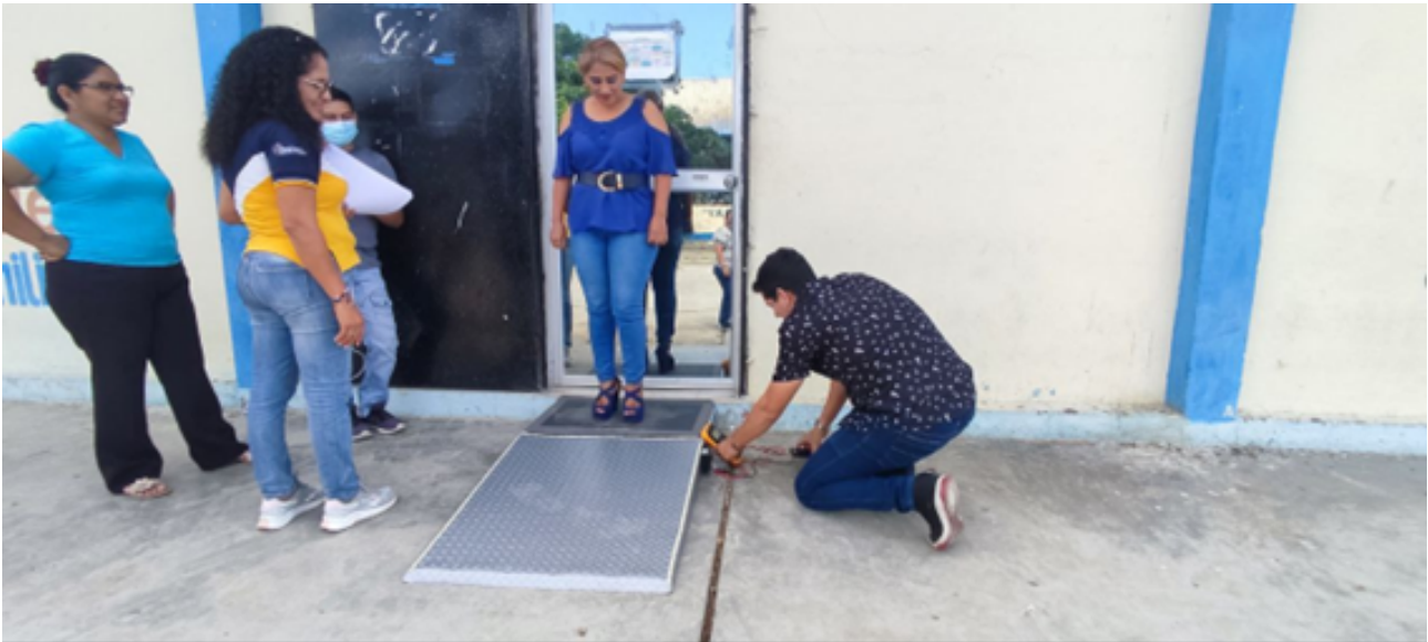
Figura 58. Medición de variación de tensión durante utilización de alfombra piezoeléctrica, por E. Alvarado y C. Verdezoto
