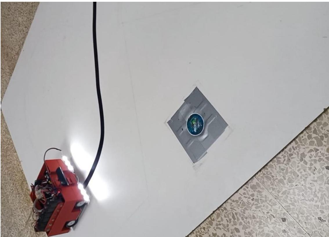
Figura 32. Funcionamiento del robot seguidor de línea en una pista abierta.
