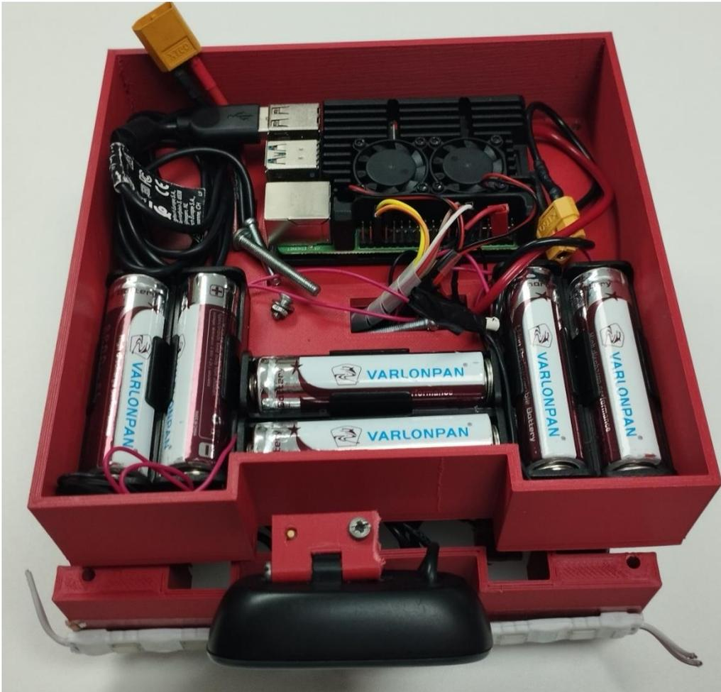
Figura 27. Ubicación de las baterías y la Raspberry en la planta alta.
