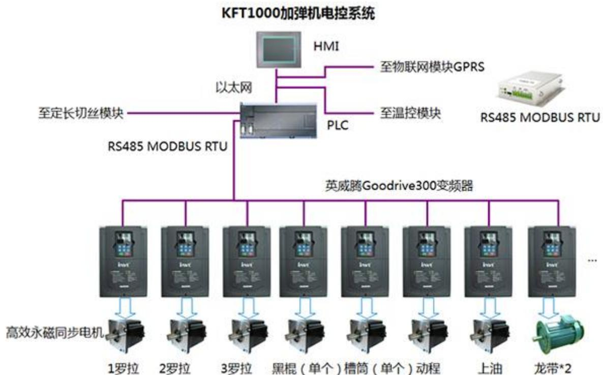
Figura 15. Sistema de control eléctrico de máquina de textura KFT1000. [17]
