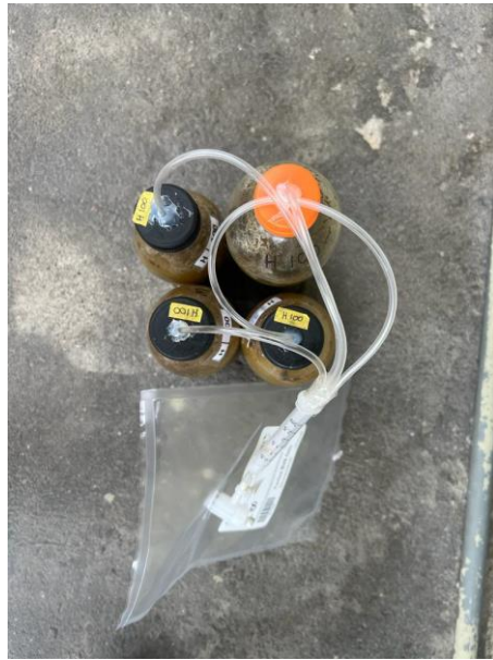
Ilustración 9 Recolección de biogás en la funda Tedlar para determinar la concentración de metano
