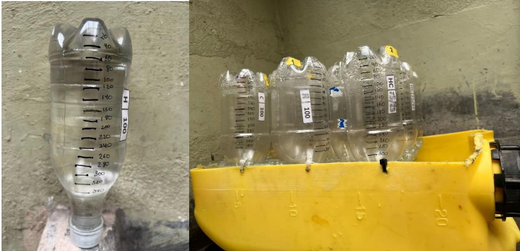
Ilustración 6 Botellas graduadas previo a conectar la manguera de los reactores
