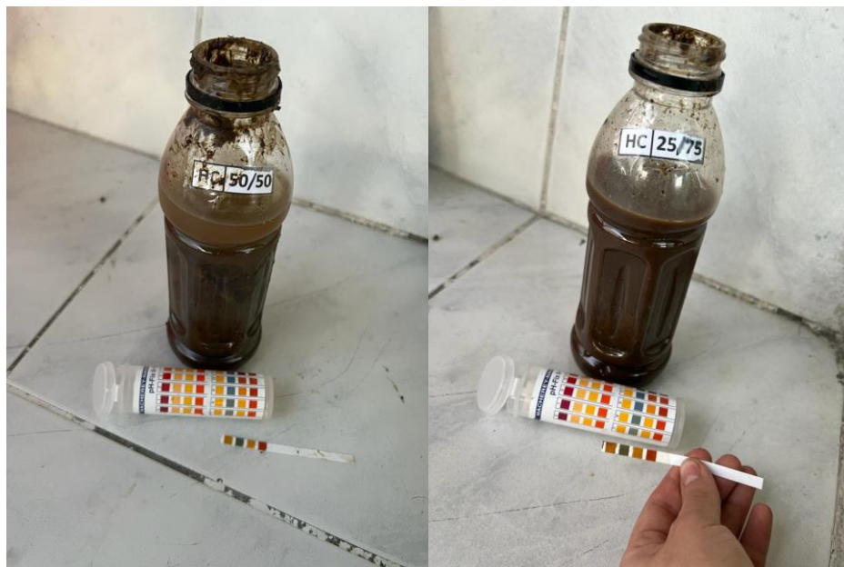
Ilustración 5 Determinación del pH previo a cerrar los biorreactores
