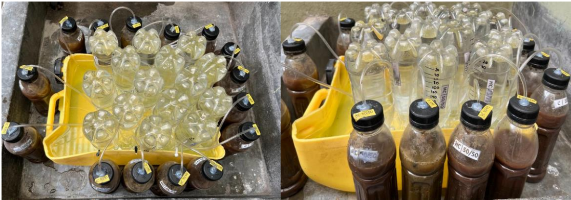
Ilustración 7 Biorreactores sellados y funcionando
