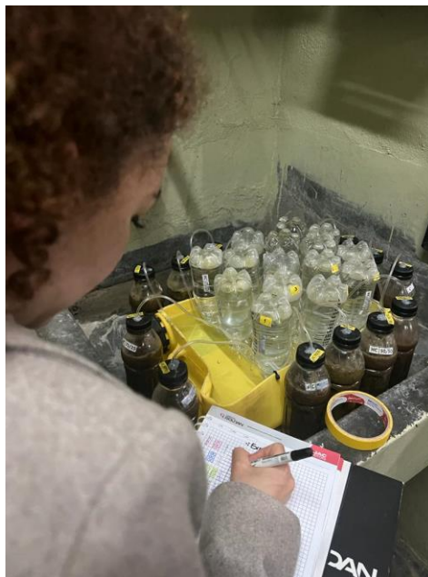
Ilustración 8 Registro de los datos del volumen de biogás generado
