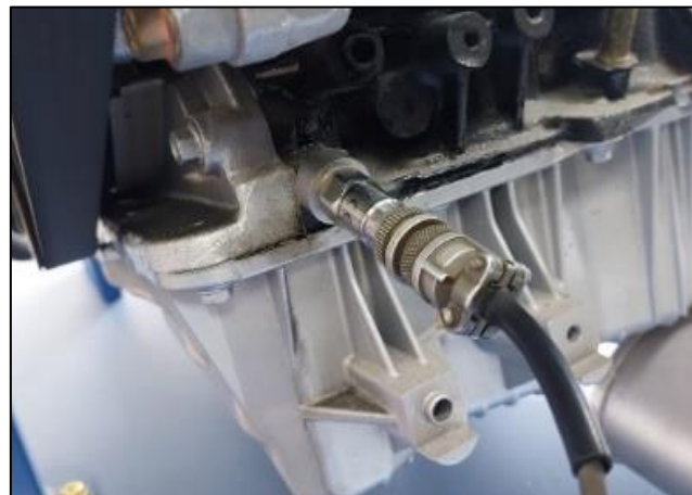
Figura 23 Punto de referencia para la toma de datos de vibración en el motor
