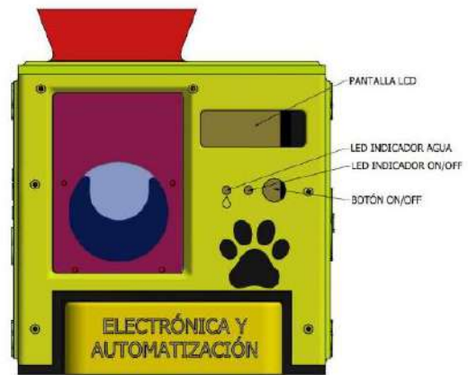
Ilustración 5: Control del módulo.
