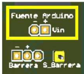
Ilustración 60. Ubicación de la Alimentación del Arduino dentro de la tarjeta electrónica
