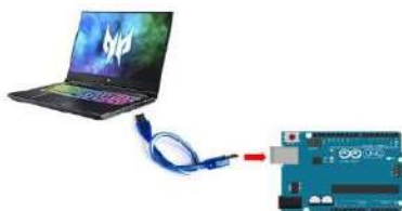
Ilustración 54. Conexión de Arduino hacia la entrada USB de la Computadora o Laptop
