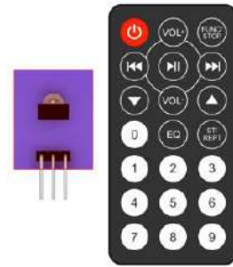
Figura 63. Componentes utilizados para el Sistema de Acceso (Uso del control infrarrojo)
