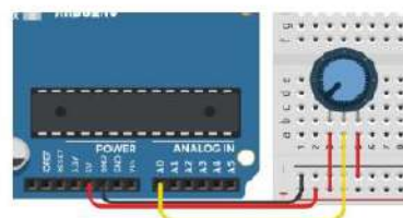
Ilustración 25. Conexión del potenciómetro al Arduino
