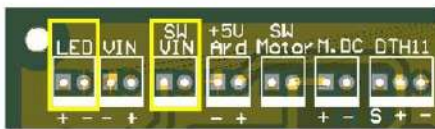
Ilustración 33. Ubicación donde se conecta el interruptor
