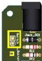
Ilustración 38. Ubicación donde se conecta el interruptor
