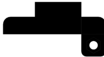
Figura 64. Soporte para el Módulo receptor del Sistema de Acceso (Uso del control infrarrojo)
