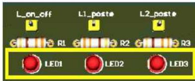
Ilustración 51. Ubicación de los leds dentro de la tarjeta electrónica
