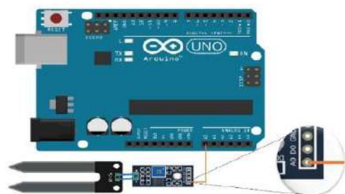
Ilustración 15: Conexión de control de Sensor FC - 28
