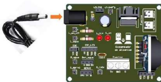
Ilustración 45: Alimentación del módulo
