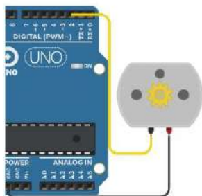
Ilustración 18. Conexión del Motor con el Arduino
