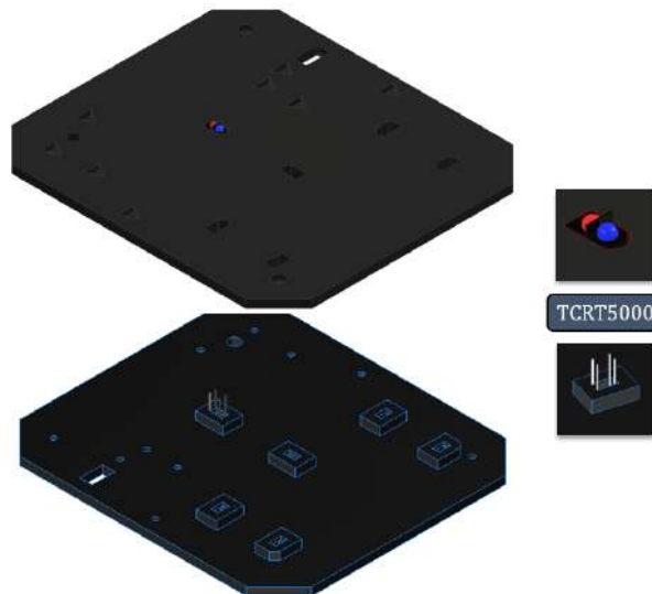
Figura 19. Vista superior e inferior de la base principal donde estarán colocados los soportes y sensores
