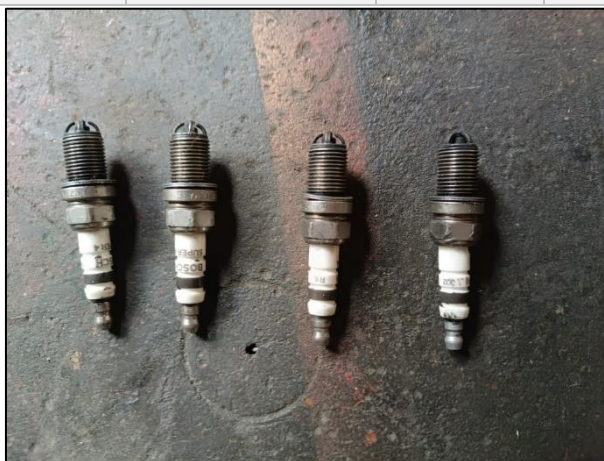
Figura 2-3. Estado de las Bujías. 50
