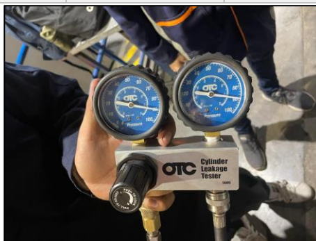
Figura 2-10. Comprobación de fugas. 65
