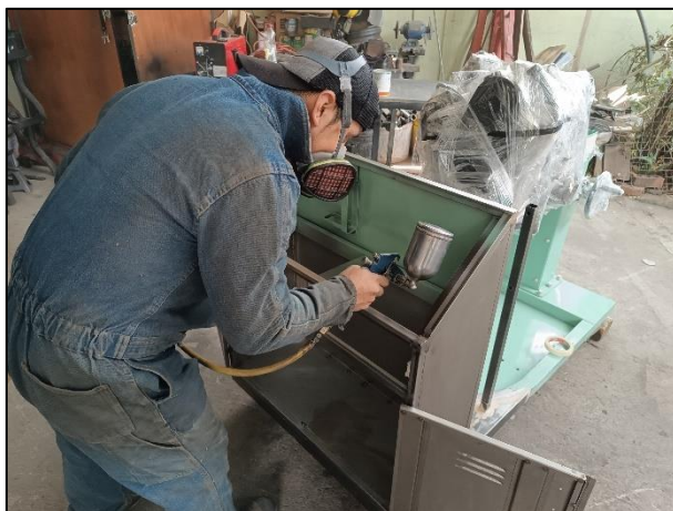
Figura 3-13. Proceso de pintura del panel de diagnóstico. 85
