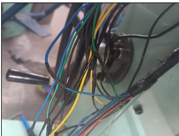
Figura 3-14. Conexiones eléctricas para sensores y actuadores del motor. 86
