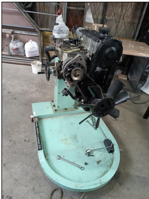
Figura 3-10. Montaje del motor en el soporte. 82
