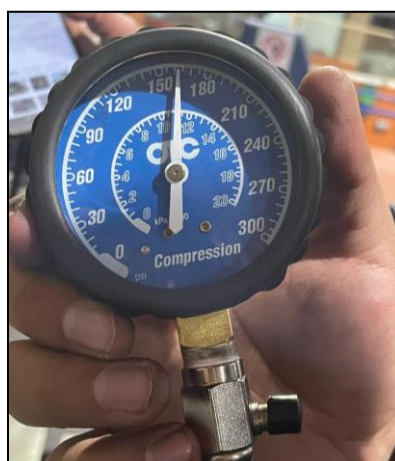
Figura 2-9. Comprobación de compresión en el cilindro. 63
