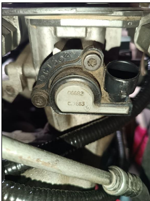
Figura 2-4. Inspección visual de sensor TPS. 52
