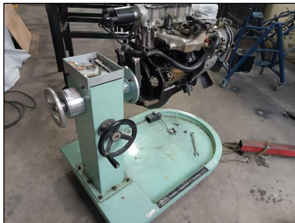
Figura 2-13. Montaje de motor sobre el nuevo soporte. 69
