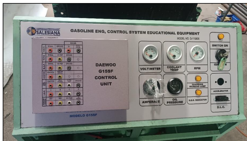
Figura 3-17. Instalación de los medidores del panel de diagnóstico. 89
