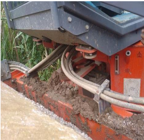
Figura 112 Conductos del sistema hidráulico para el accionamiento de la compactadora
