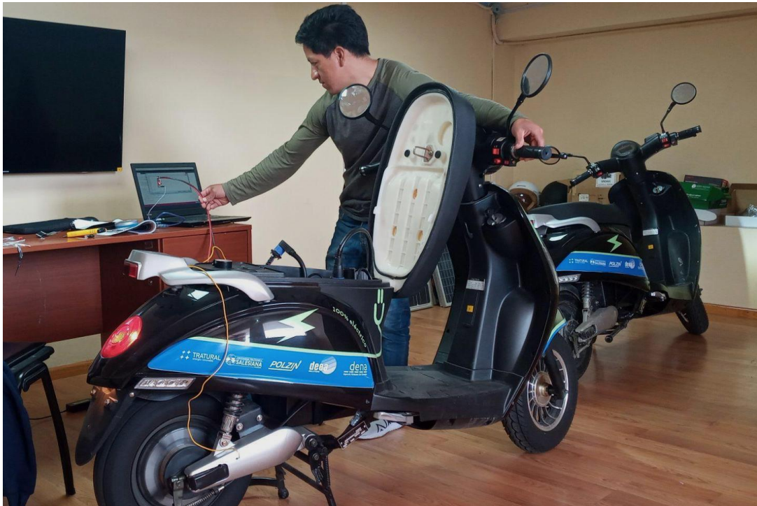
Figura 2.3. Medición de voltaje y corriente de la batería.
