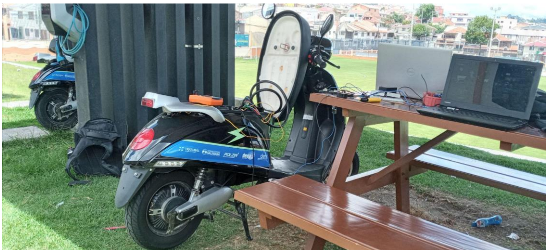
Figura 2.4. Comprobación de voltaje de batería.
