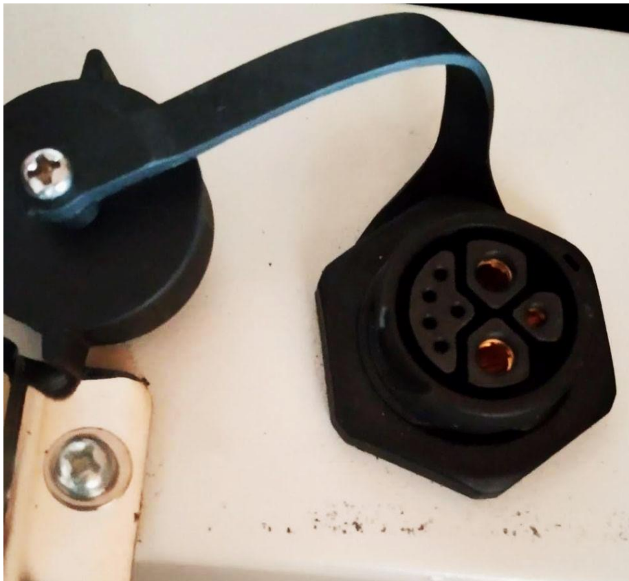
Figura 2.2. Entrada de cable chogori M23 a la batería.
