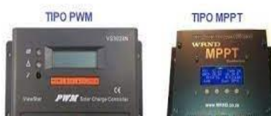
Figura 4 Controlador de Carga
