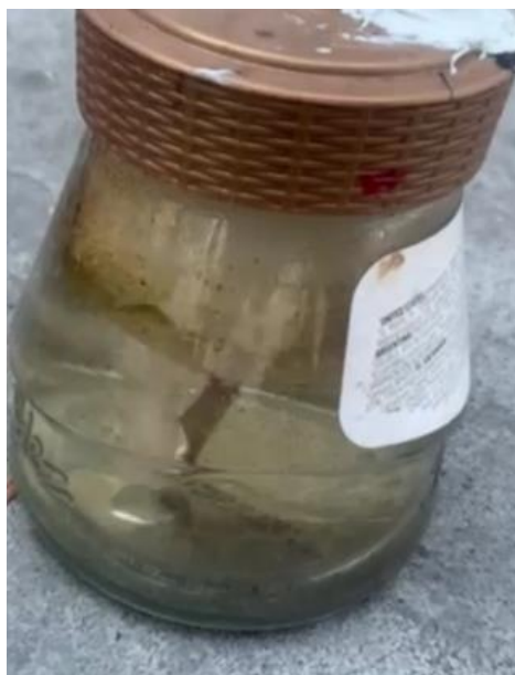
Ilustración No. 37: Ingreso del gas al filtro de agua
