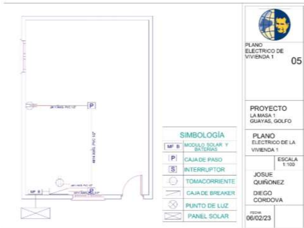
Figura 29: Diagrama unifilar de puntos de luz en AutoCAD.
