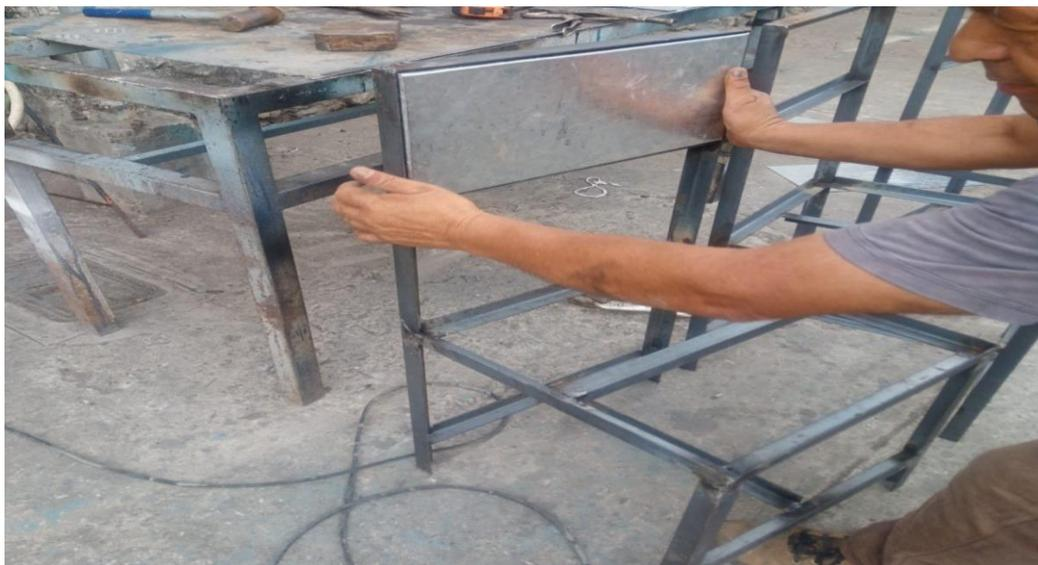
Figura 53. Fabricación de estructura base para sistema fotovoltaico (Fuente: Autores).
