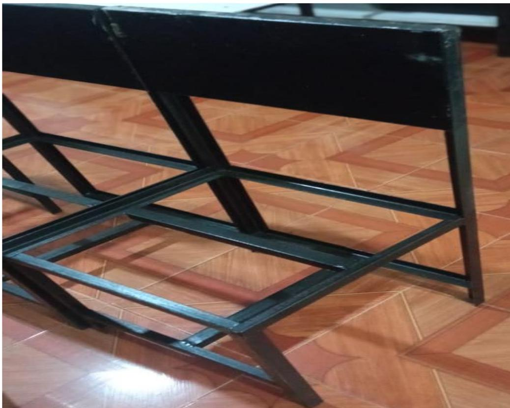
Figura 54. Estructura base para sistema fotovoltaico terminada (Fuente: Autores).
