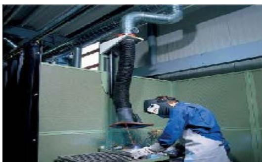
Figura 4.28.9.15.a: Protección con ventilación forzada,
