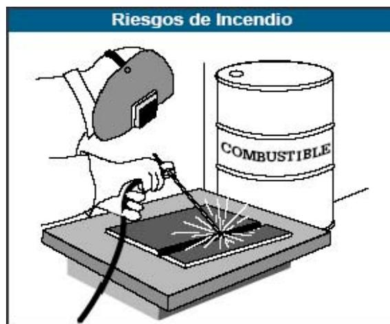
Figura 4.28.9.3.a: Riesgo de incendio, máquinas soldadura de arco.
