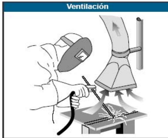
Figura 4.28.9.3.b: Riesgo de ventilación, máquinas soldadura de arco.
