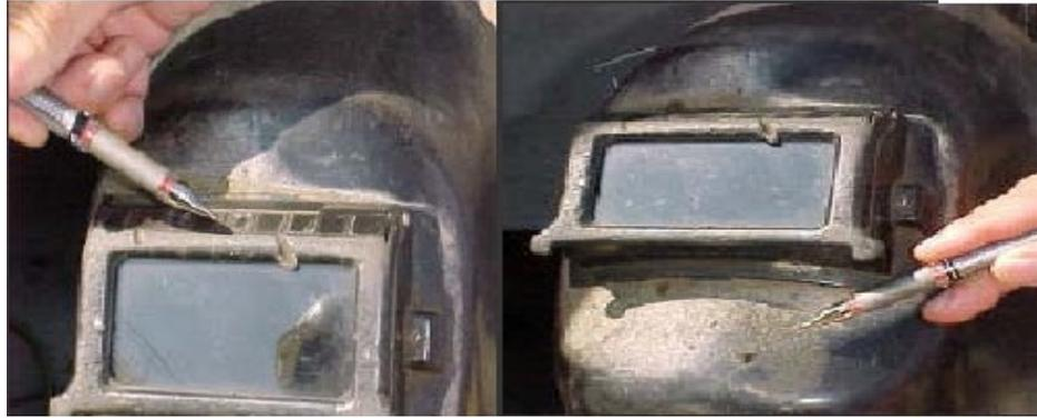
Figura 4.28.9.11.b: Máscara para soldar deteriorada,
