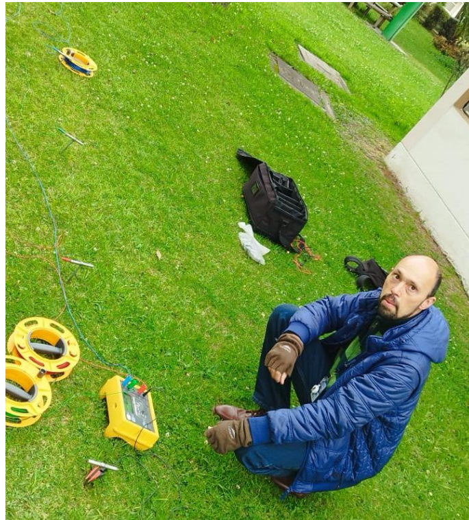
Figura 24. Verificación de Wenner alfa con una separación de 1 metro
