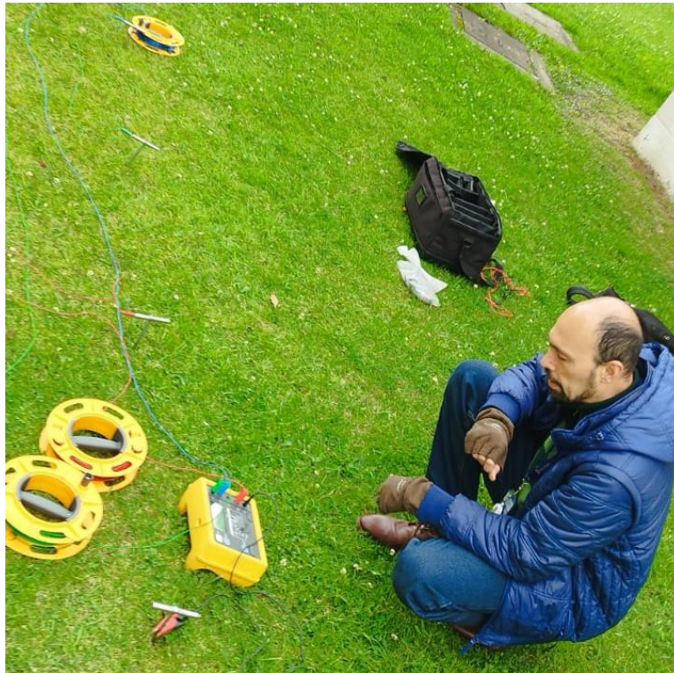
Figura 28. Verificación de Wenner gamma con una separación de 1 metro
