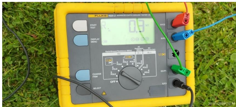
Figura 21. Verificación del resultado de Wenner beta con una separación de 2 metros
