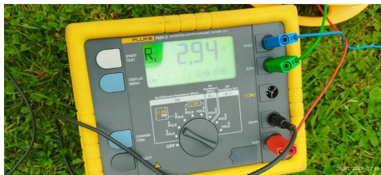
Figura 23. Verificación del resultado de Wenner gamma con una separación de 2 metros
