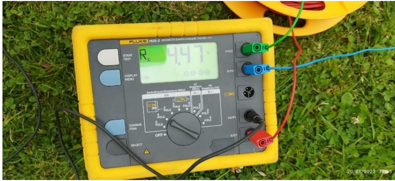
Figura 19. Verificación del resultado de Wenner alfa con una separación de 2 metros
