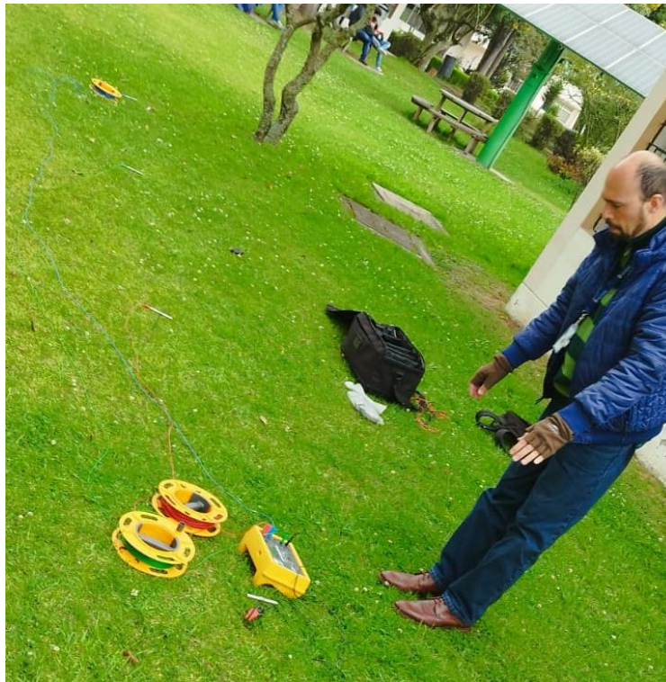
Figura 20. Verificación de Wenner beta con una separación de 2 metros
