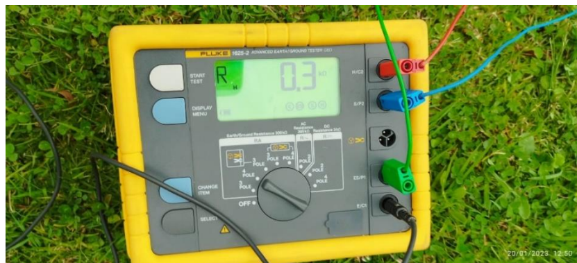
Figura 27. Verificación del resultado de Wenner beta con una separación de 1 metro
