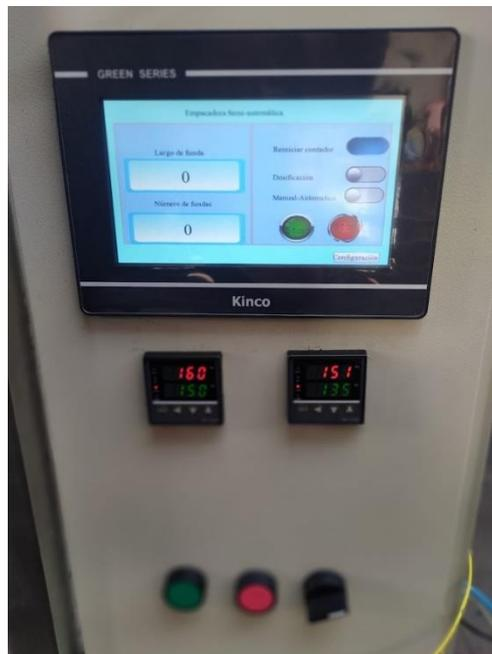
Figura 60: Implementación del HMI en el gabinete
