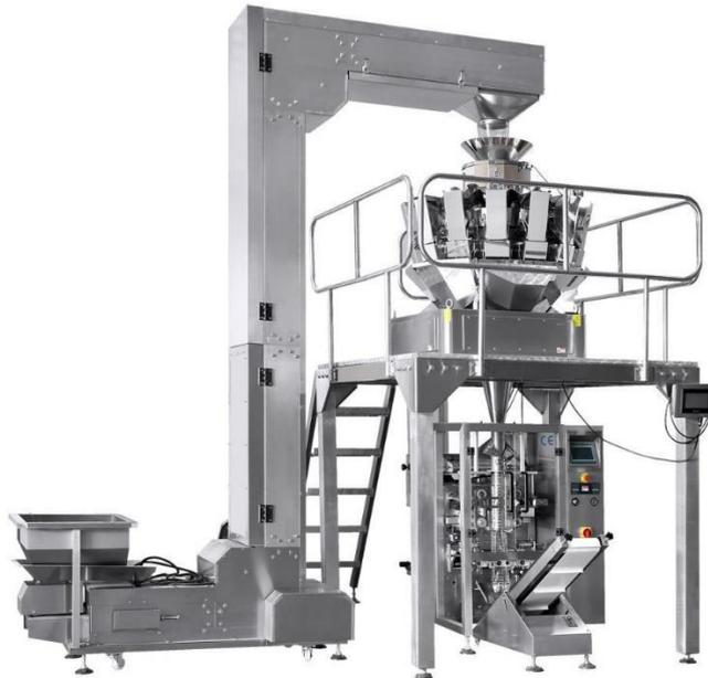
*Figura 4: Multicabezal automático de balanzas [5].*
