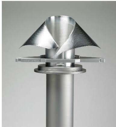
Figura 8: Formador para empacadoras verticales [3].
