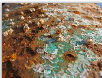
Figura 1.8. Corrosión de metales
