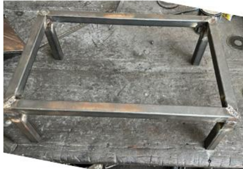
Figura 40. Marco y soportes de la mesa.
