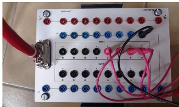
**Figura 36.** Módulo de entradas y salidas Festo.
