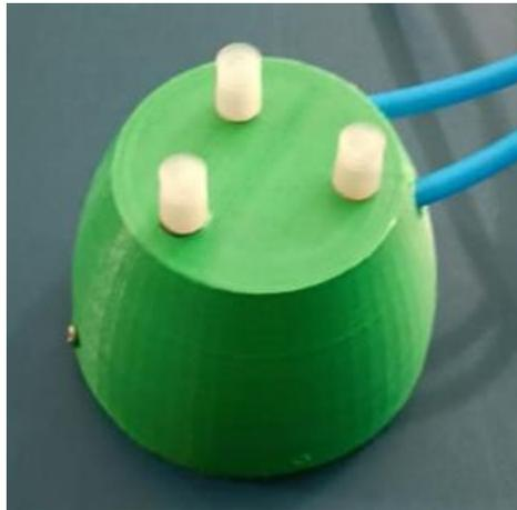
**Figura 32.** Implementación de la Pinza flexible.
