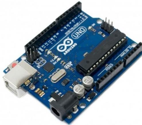
**Figura 19.** Controlador Arduino UNO.
