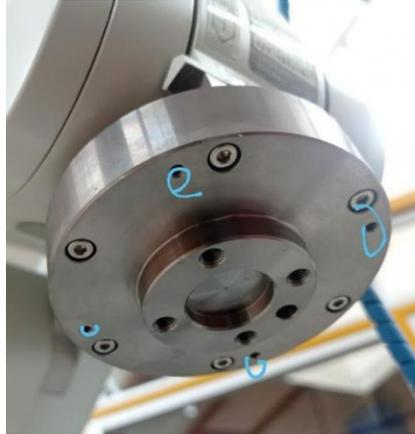
**Figura 23.** Puntos de sujeción en la Pinza flexible.
