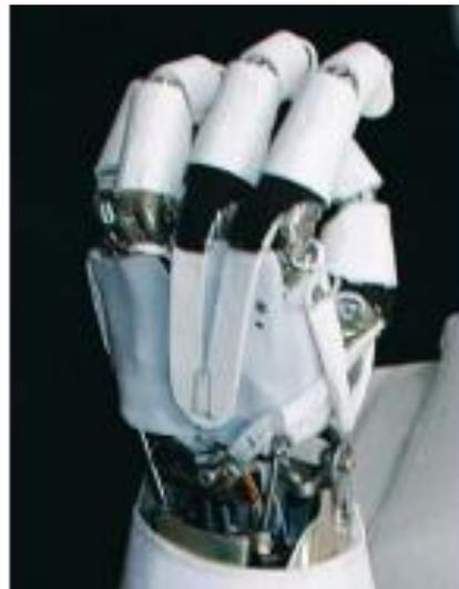
**Figura 8.** Mano robótica Robonaut [6].
