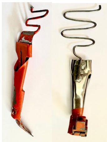
Figura 17. Folder de tipo sobre cinta fabricado a mano.
