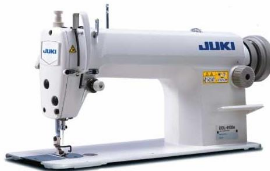
Figura 4. Máquina recta plana de una aguja [5].
