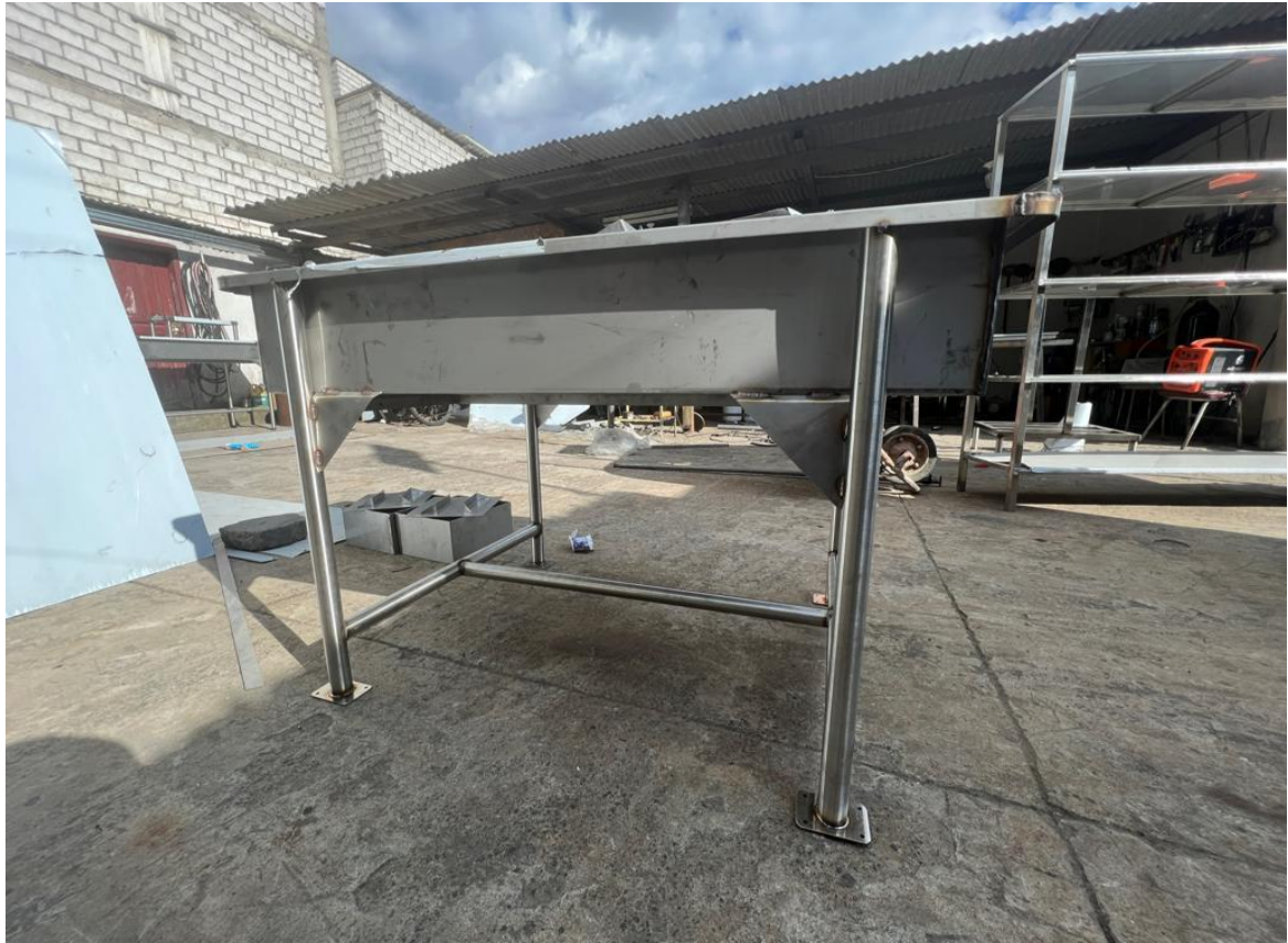
Figura 62. Proceso de soldadura y armado, resultado de soldadura de saladero.
