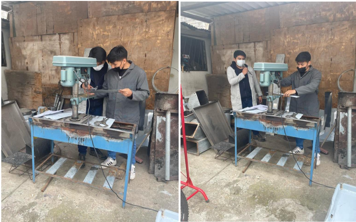
Figura 66. Proceso de taladro de moldes, ubicación de agujeros según especificaciones de plano.
