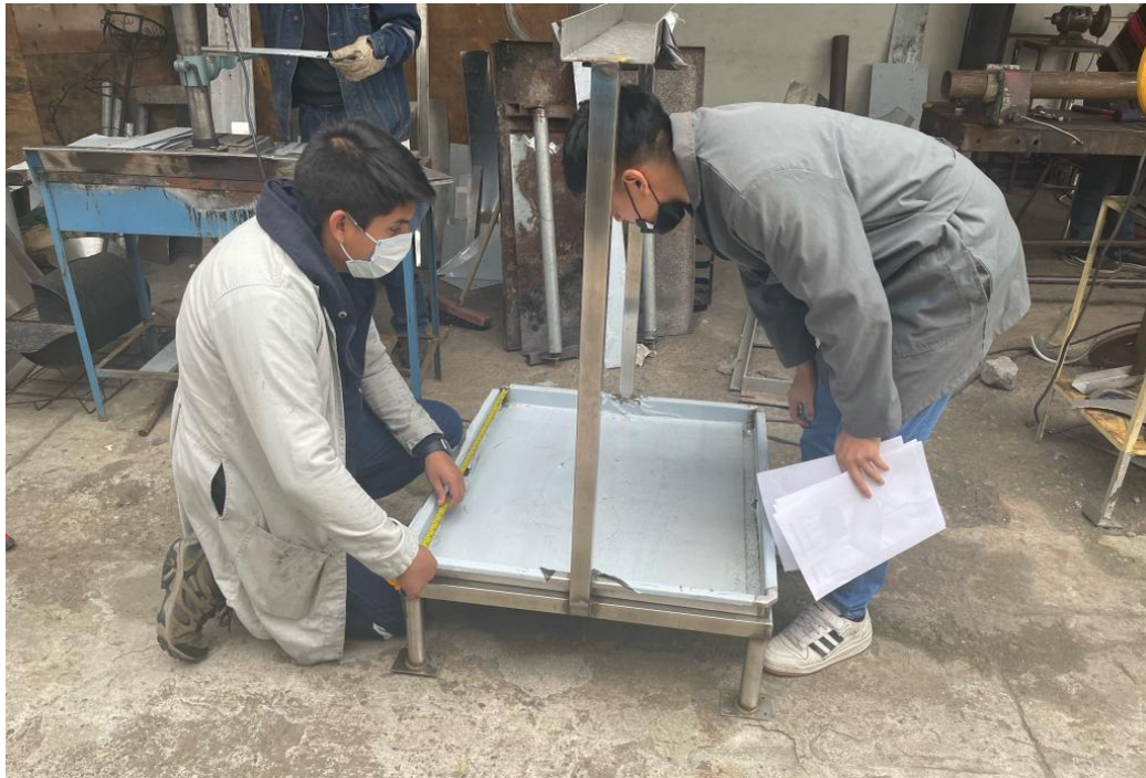
Figura 64. Proceso de verificación de medidas y corrección de detalles, prensa mecánica.
