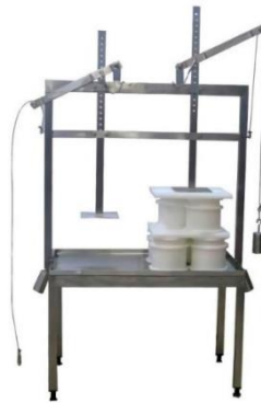
Figura 7. Prensa de queso mecánica, [17].
