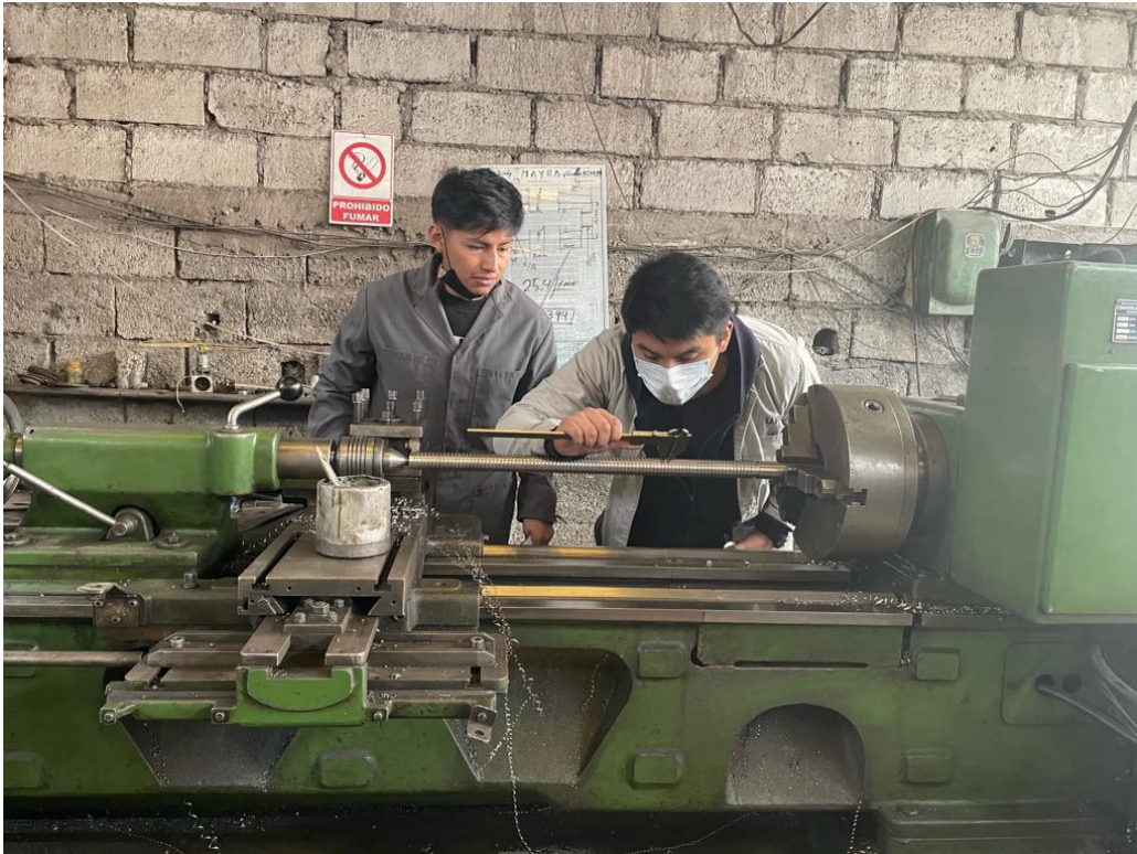
Figura 67. Proceso de torneado de sistema mecánico, cálculo de ranuras de tornillo de prensa mecánica.
