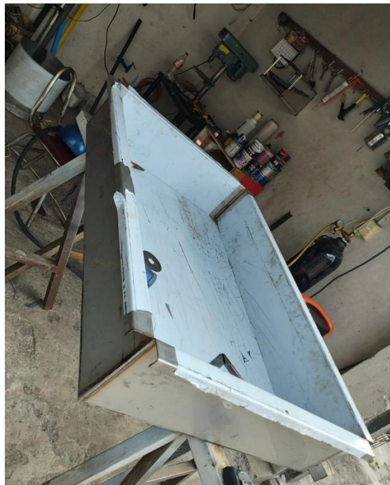
Figura 59. Proceso de dobladura y corte, resultado de doblaje en saladero.
