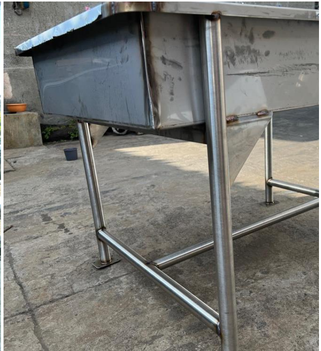
Figura 63. Proceso de soldadura y armado, soldadura de saladero.
