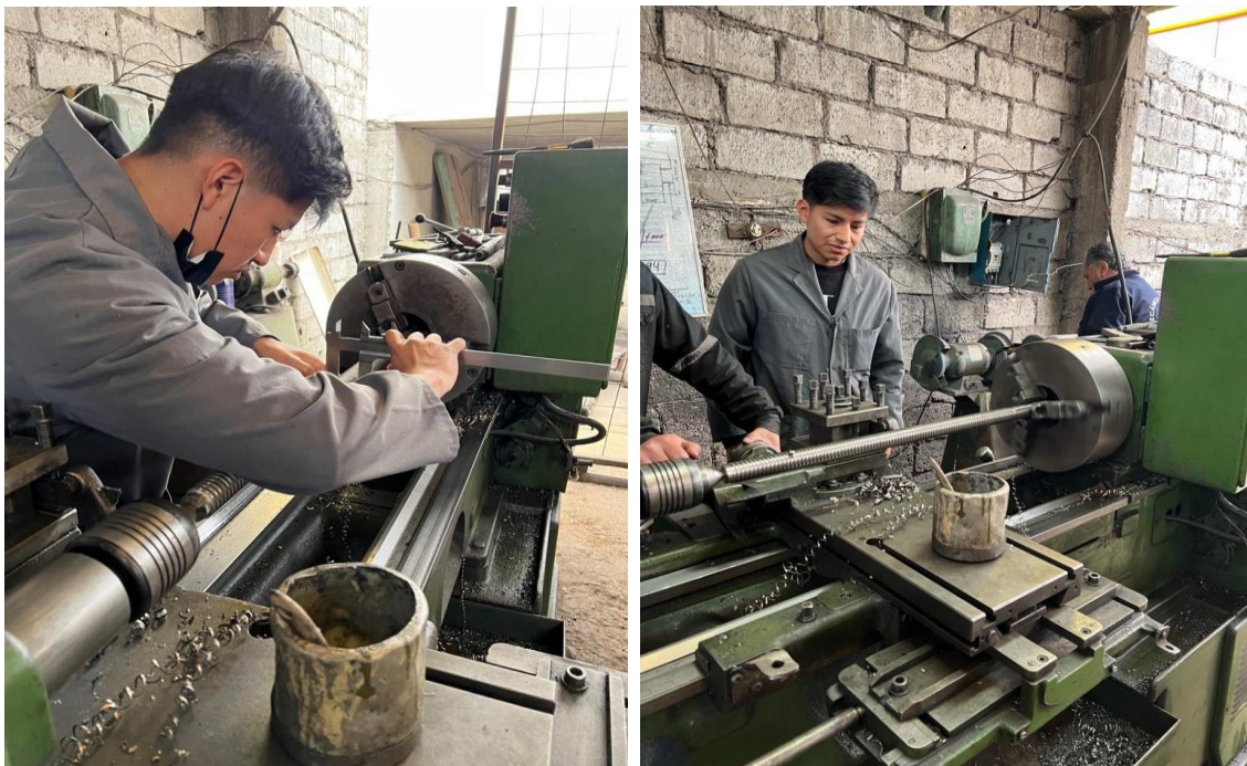
Figura 68. Proceso de torneado de sistema mecánico, elaboración de tornillo de prensa mecánica.
