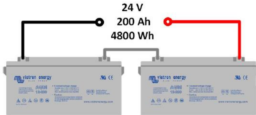
Figura 19. Baterías conectadas en serie
