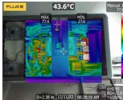
Figura 64 Termografía del tablero de transferencia manual
