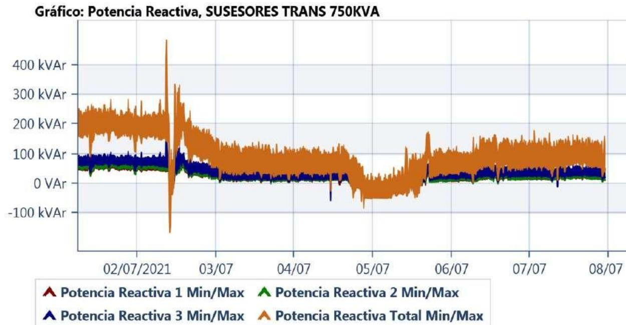
**Figura 42** Potencia reactiva en transformador 1
