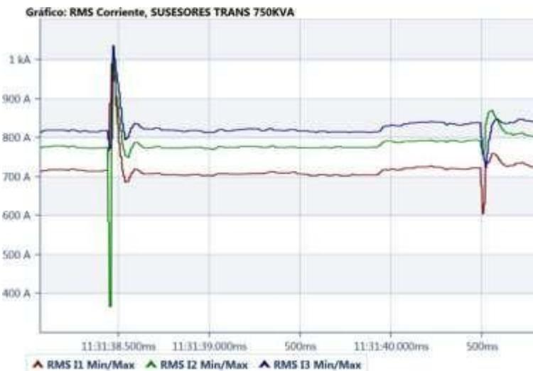
**Figura 37** Corriente RMS durante caída de tensión en transformador 1, periodo 1
