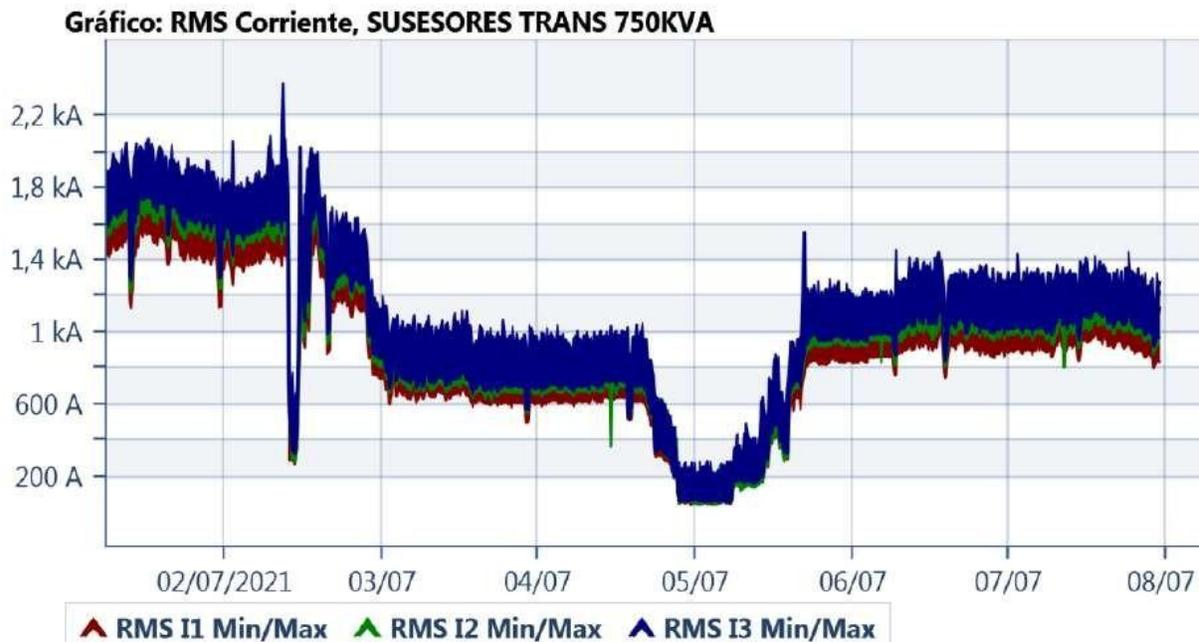
**Figura 40** Corriente trifásica en transformador 1
