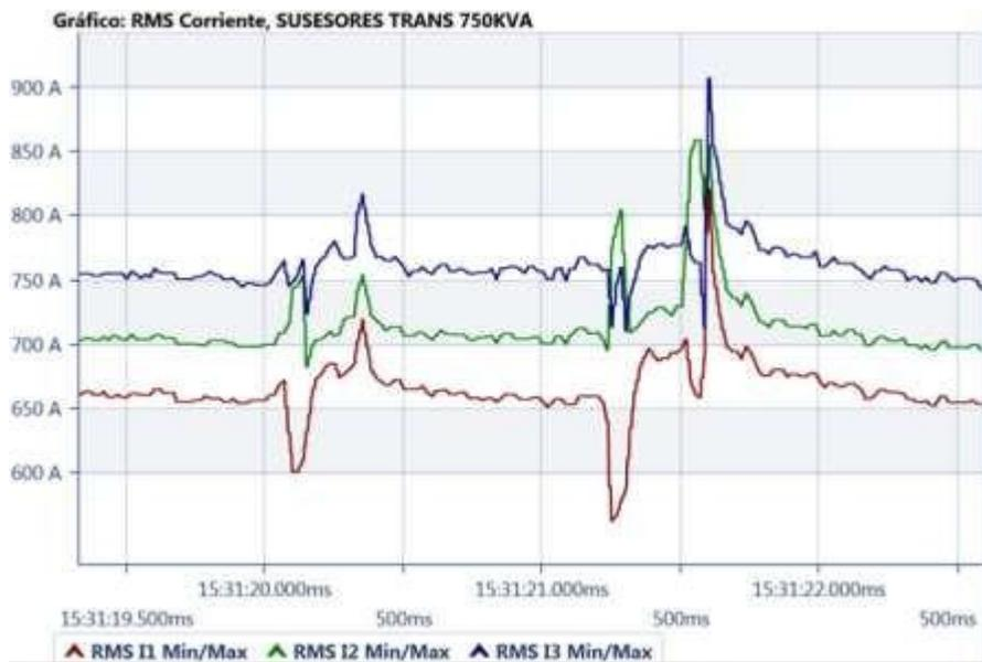
**Figura 39** Caída de tensión en transformador 1, periodo 2
