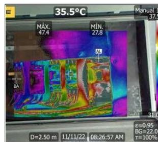
**Figura 69** Termografía de breaker secundario 2 del chiller 2
