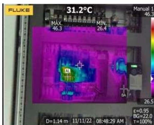
Figura 62 Termografía de breaker principal del TC empacadora Fava 2200
