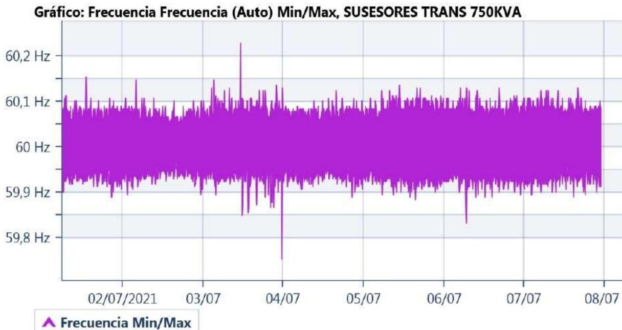
**Figura 34** Tendencia de frecuencia transformador 1
