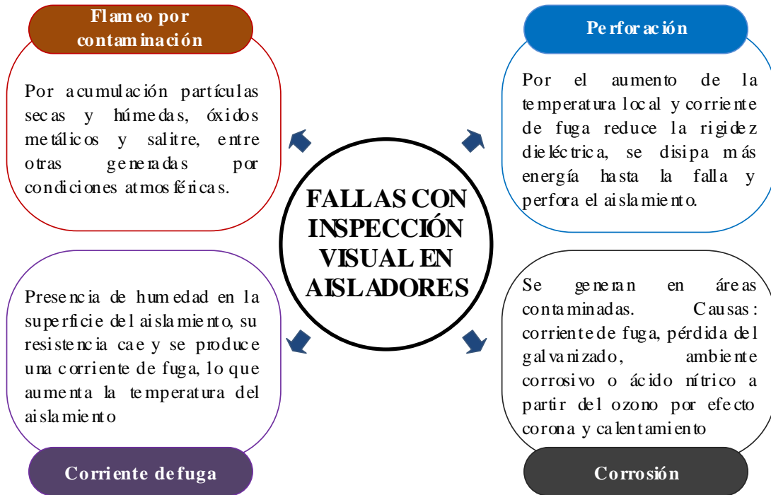
Figura 11 Fallas detectadas con inspección visual en aisladores.
